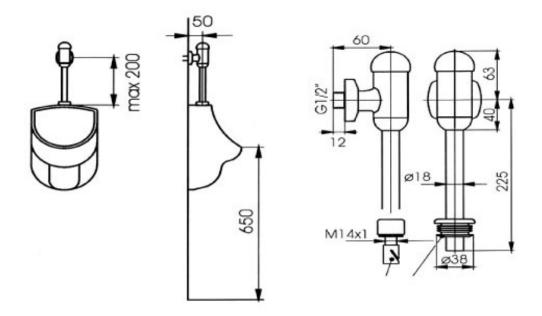
Для использования крана необходимо нажать на сферическую кнопку. Произойдет открытие клапана смыва, затем клапан автоматически закроется.
