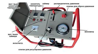
Переведите рычаг распределителя давления на «сведение труб», сведите торцованные поверхности и проверьте совпадение стенок труб. Допустимый зазор между торцами не должен превышать 10% от толщины свариваемой трубы. При необходимости отрегулируйте зазор между торцами, затягивая гайки внутренних хомутов.
