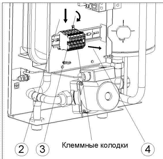
Рисунок 18. Замена клеммных колодок
