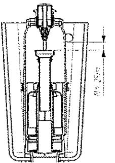
Отрегулируйте высоту трубы перелива арматуры спускной так, чтобы верхний уровень трубы был не менее чем на 25 мм ниже края бачка или наиболее низко расположенного отверстия в стенке корпуса бачка.
