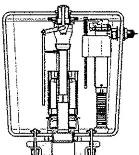
Установите наполнительную и спускную арматуру в сливной бачок таким образом, чтобы их подвижные части не касались друг друга и стенок бачка.
