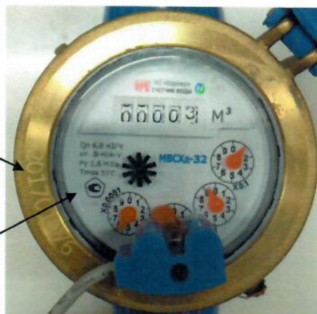
Рисунок 3 – Место нанесения знака утверждения типа и заводского номера на счётчики холодной и горячей воды крыльчатые многоструйные МВС
