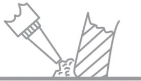
**RUS** Обработать место постаменту унитаза с полом силиконовым герметиком, чтобы предотвратить попадание воды под основание унитаза.
