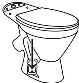
**RUS** Произвести разметку крепления унитаза к полу. Закрепить унитаз к полу при помощи специального комплекта крепежа. Внимание! Запрещается устанавливать изделие на свежеложенный пол.
