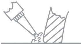
**RUS** Обработать место постамента унитаза с полом силиконовым герметиком, чтобы предотвратить попадание воды под основание унитаза.
